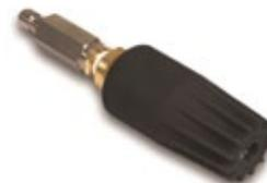
Boquilla rotativa con presión nominal máxima de 5100 psi. Sólo compatible con las lavadoras a presión STIHL RB 600 y RB 800, esta boquilla permite que el agua gire en un movimiento circular para producir una corriente de chorro a alta presión. Cuenta con un asiento y una boquilla de cerámica y un tapón de conexión rápida de 1/4" con filtro.
