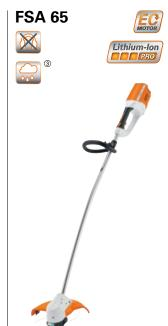
Motoguadaña a batería para trabajos de limpieza. Diámetro de la circunferencia de corte 300 mm, empuñadura blanda, manillar ajustable en progresión continua, el cabezal de corte permite bobinar hilo nuevo golpeándolo suavemente contra el suelo, peso 2,7 kg<sup>©</sup>.
