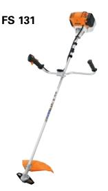
**36,3 cm³, 1,4 kW**/1,9 CV, **5,9 kg** <sup>①</sup>. Motoguadaña especialmente potente para trabajos en hierba resistente. Proceso de arranque simplificado para un arranque más cómodo, manillar abierto, empuñadura de mando con pulsador de parada, motor 4-MIX<sup>®</sup> con un mayor depósito para tiempos de funcionamiento prolongados, eje de transmisión rígido, arnés doble.
